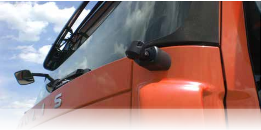
Cámara de alta resistencia instalada en la unidad tractora para aumentar la visibilidad al realizar giros.
