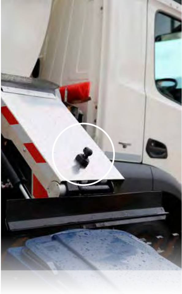
Cámara para monitorización del lateral o zona operatoria.
