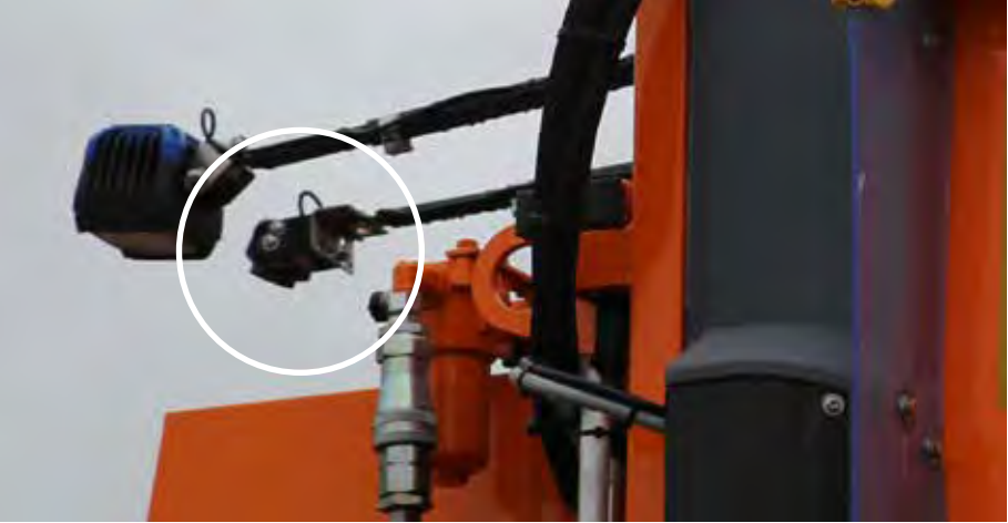
Cámaras de alto rendimiento para monitorear la zona trasera y operativa del vehículo, así como los laterales del vehículo.
