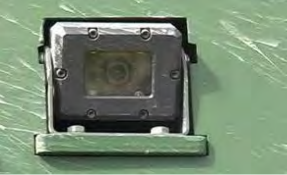
Cámaras de alta resistencia integradas en el chasis del vehículo para monitorear los laterales del vehículo.
