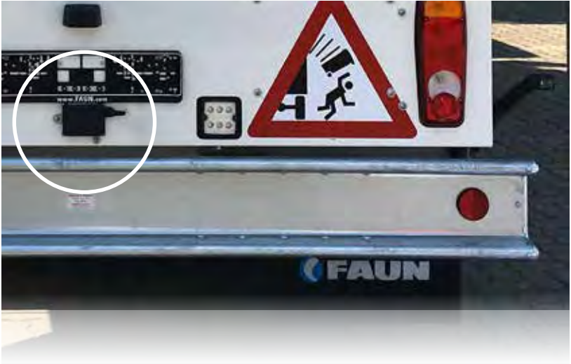
Vehículo recolector de basura con sensor de radar en la parte trasera.
