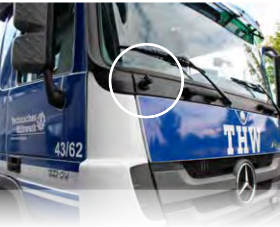
Las unidades tractoras con cámara de alta resistencia aumentan la seguridad al realizar giros (abajo).
