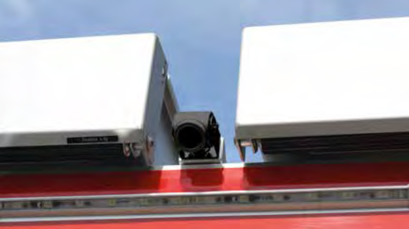
Cámara robusta para monitorizar la zona trasera del vehículo (izquierda).
