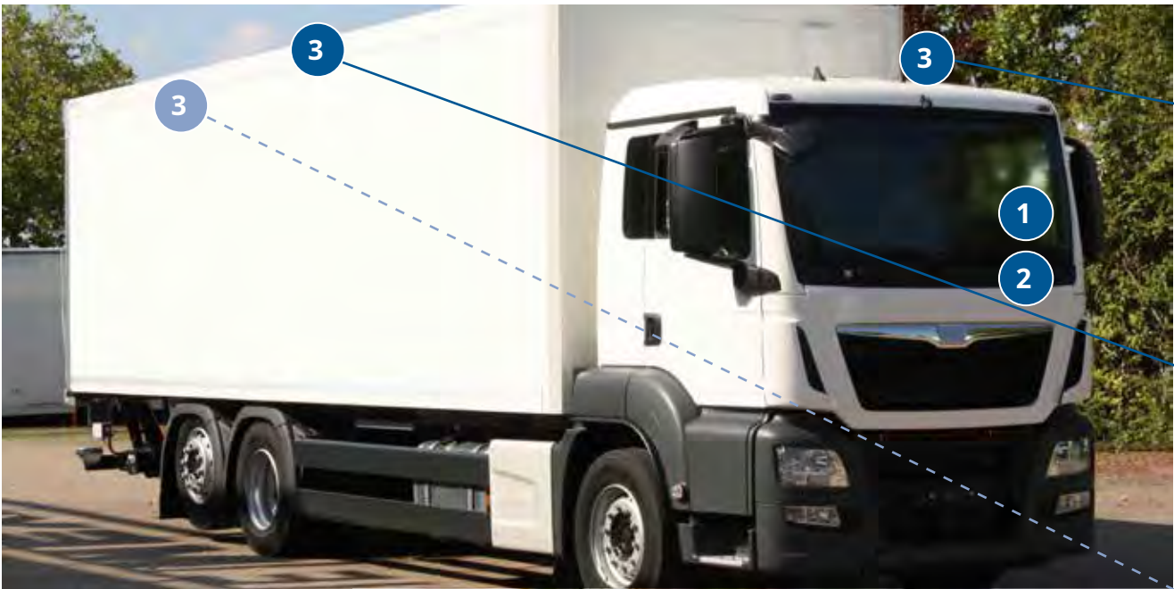
Posiciones de instalación de las cámaras MVS. Frontal, laterales y parte trasera para una vista aérea de 360°.
