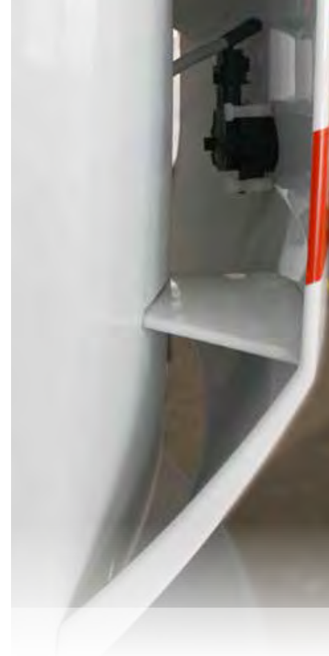
Posiciones de instalación de los sensores de ultrasonidos en la parte delantera y lateral del vehículo.
