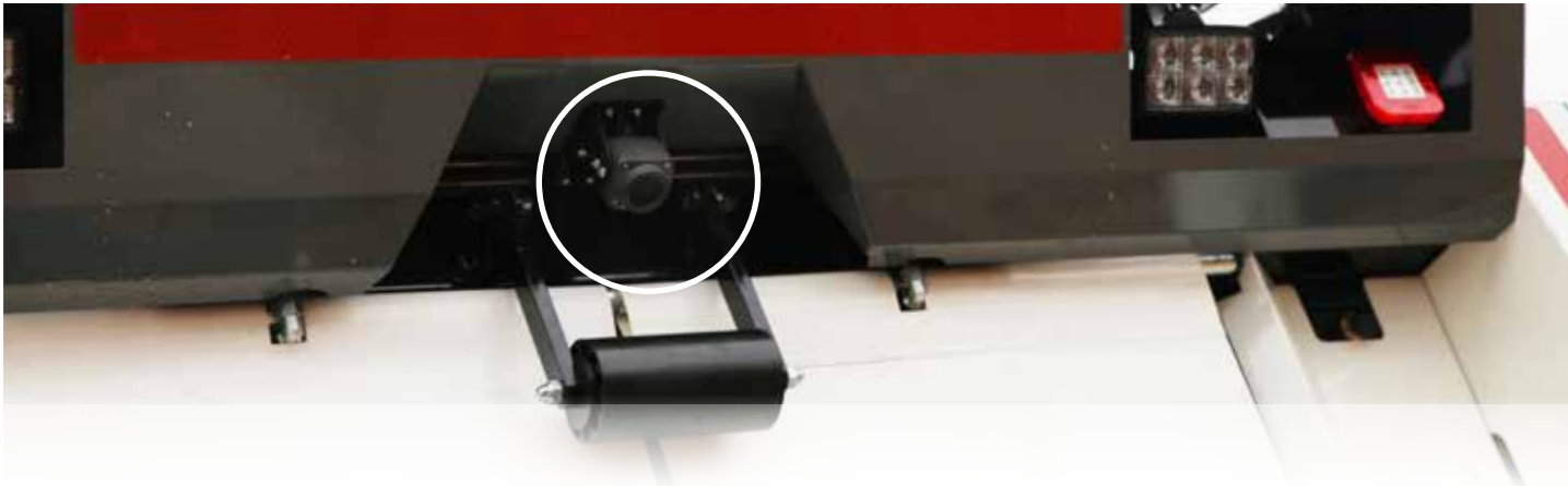
Cámara de alta resistencia para monitorear las áreas traseras y operativas.
