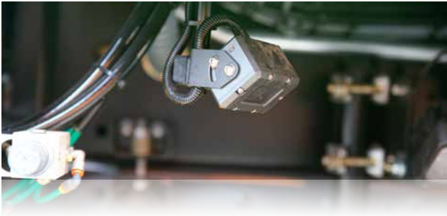
Usando una cámara para monitorear los cepillos de la barredora.
