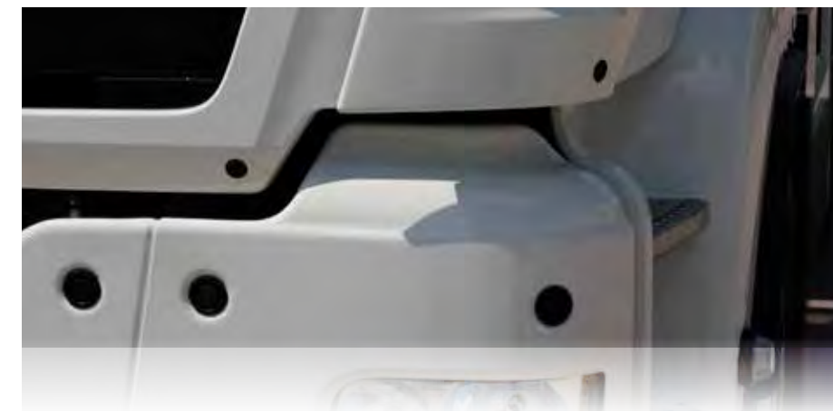
Posiciones de instalación de los sensores de ultrasonidos en la parte delantera y lateral del vehículo.
