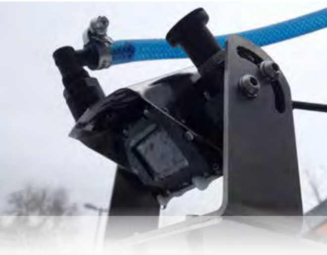
Cámara lateral para supervisar la cuchilla desbrozadora (arriba a la izquierda). Cámara de visión trasera de alta resistencia con sistema de limpieza (abajo a la izquierda).
