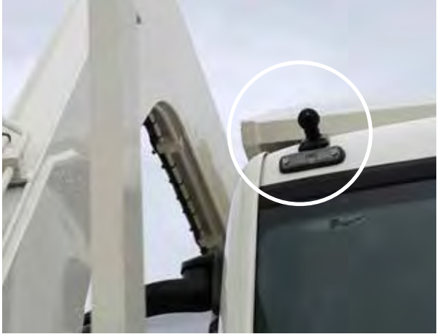
Vehículos de recogida de basura con cámara para monitorización de la zona delantera del vehículo.
