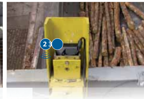
MC3000B para monitorear el nivel de llenado de un contenedor de madera.
