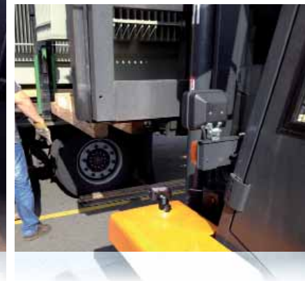
Carga de camión asistida por cámara.
